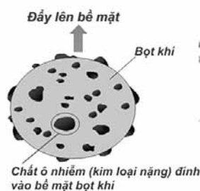
▲ Hình 4. Sơ đồ tuyển nổi và tách chất ô nhiễm
